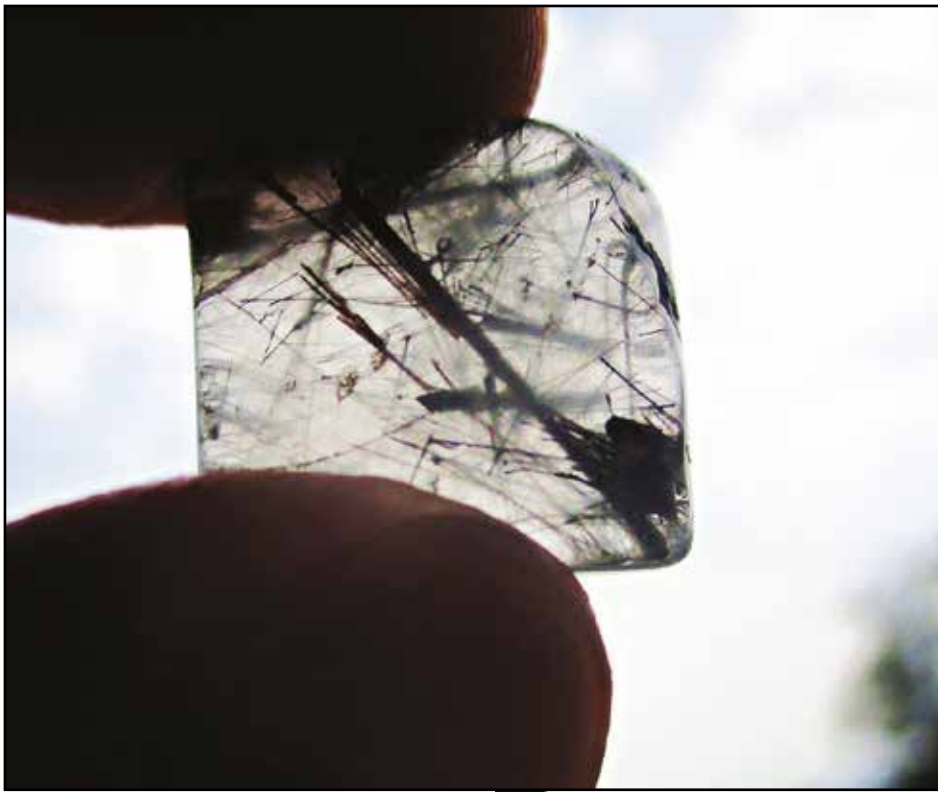
Fig. 4: sottili cristalli di tormalina possono essere inclusi anche dentro altri minerali. Nella foto si notano degli aghi di tormalina nera entro il quarzo.
