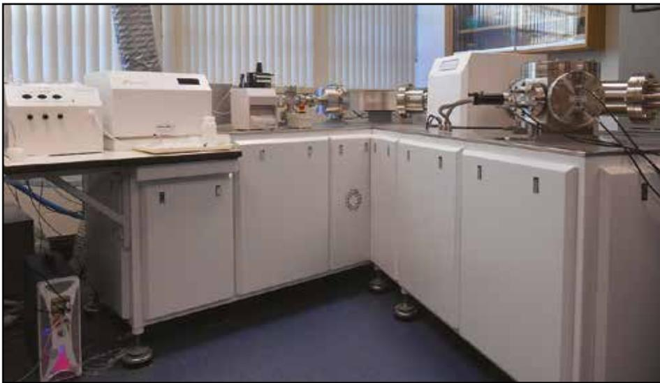
Strumento necessario per stabilire una datazione assoluta (spettrometro di massa (qui mod. Nu Plasma ICP-Mass Spectrometer (Department of Geological Science University of Florida))).
