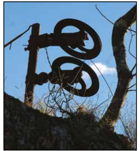
... pulegge di rinvio fissate e tirantate ancora collegate l'una all'altra dai cavi d'acciaio per il taglio ... ; pressi di Poklon (Monrupino) (Carso Triestino); 6 Gennaio 2019. (Foto R. Ferrari)
