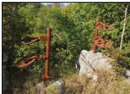
... pulegge di rinvio fissate e tirantate ancora collegate l'una all'altra dai cavi d'acciaio per il taglio... ; pressi di Poklon (Monrupino) (Carso Triestino); 16 Settembre 2018. (Foto R. Ferrari)
